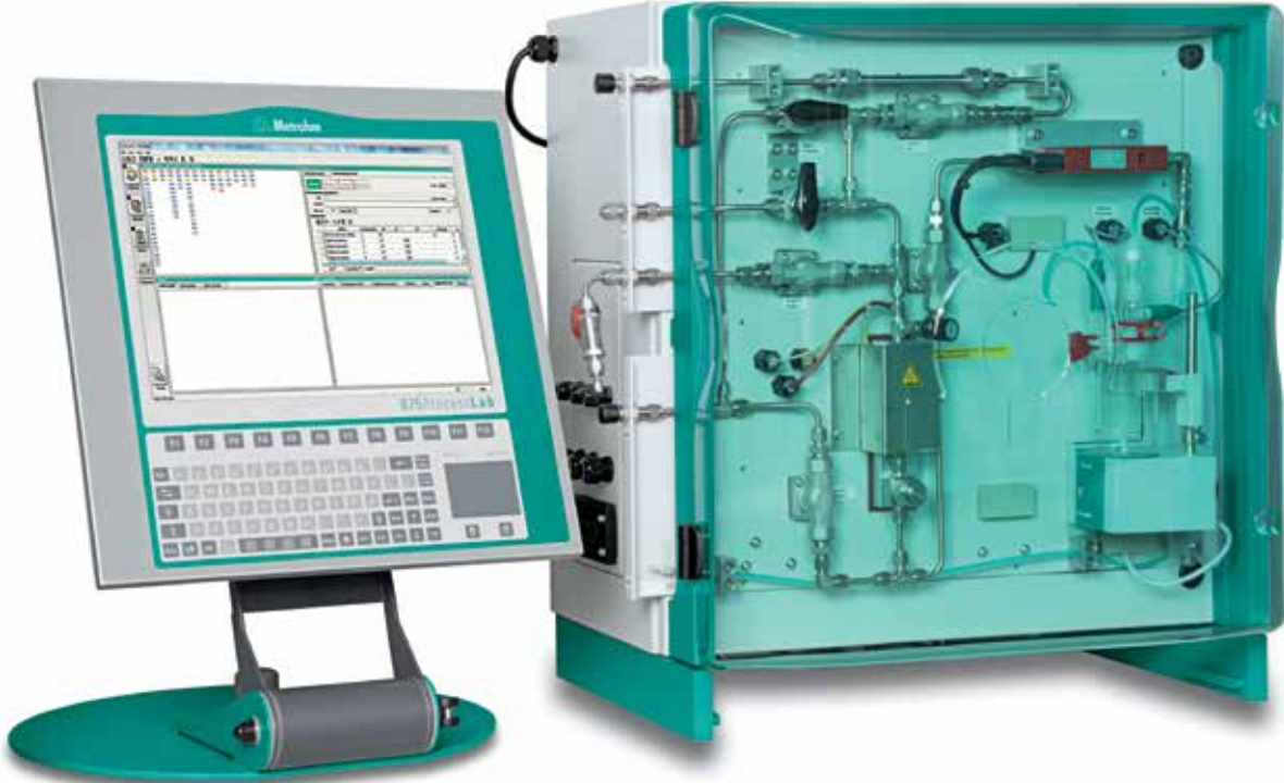
875 KF Gas Analyzer - yönetim birimi ve analiz modülü. Entegre buharlaştırıcı, dört manyetik valf ve tiamo™ kontrol ve veritabanı yazılımı, sıvılaştırılmış ve sürekli gazlarda tam otomatik ve yüksek hassasiyete sahip kulometrik su miktar analizlerine olanak tanımaktadır.
