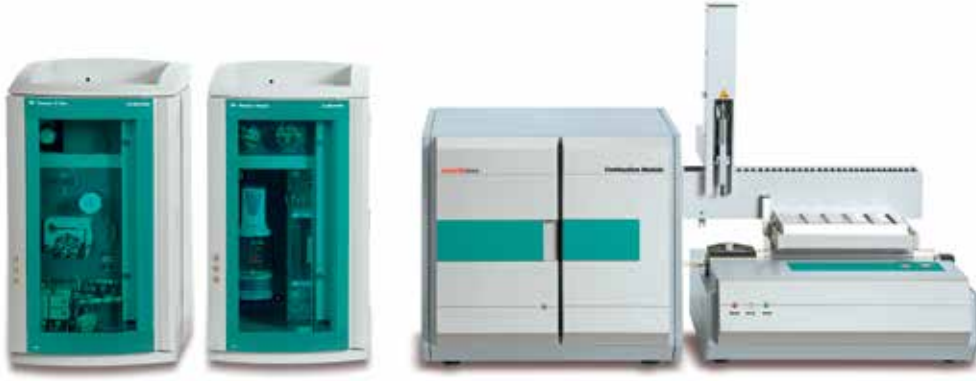
Yakma İyon Kromatografi sistemi, bir 930 Compact IC Flex, 920 Absorber Modülü ve Autosampler MMS 5000 ile donanımlandırılmış bir Analytic Jena Yakma Modülü içermektedir.
