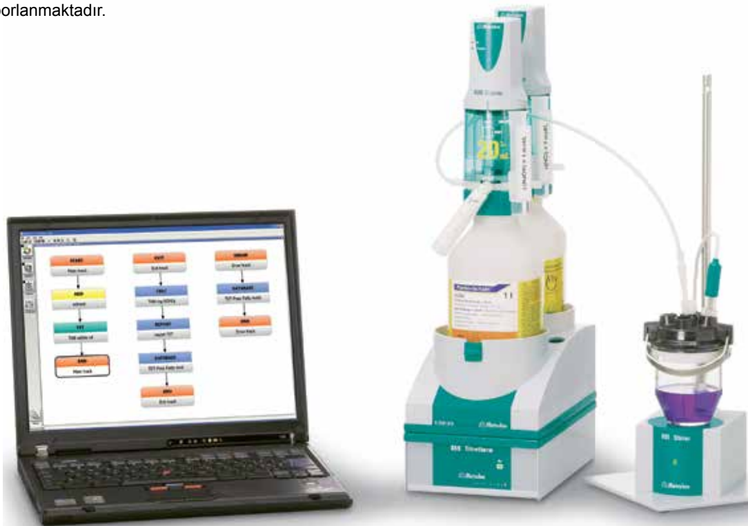
Kompakt boyutlar: 859 Titrotherm (ortada) ve 801 Stirrer
